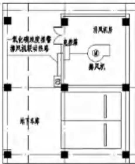
无建筑设备监控系统的联动平面
