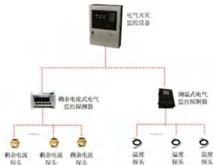
电气火灾监控系统构成示意图
