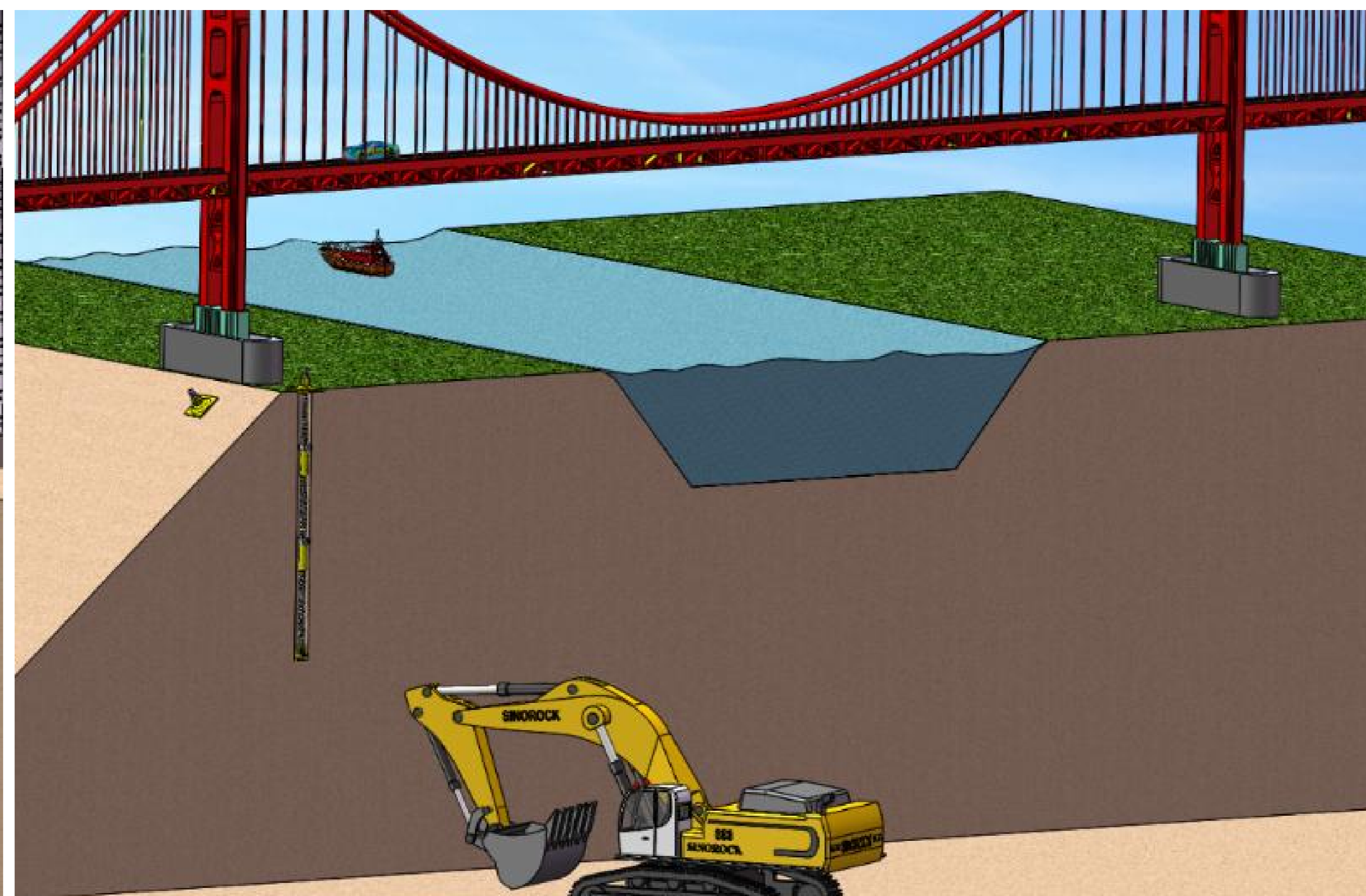
桥梁底部桥墩微型桩支护
